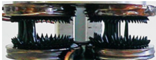
80 mT-Magnetfluid – Säulenbildung und „Spikes“ im Magnetfeld zwischen Elektromagneten
